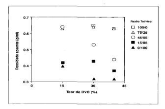
**Fig. 1**-Variação da densidade aparente com o teor de DVB e da razão tolueno/heptano em 120% de diluição.
