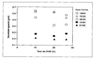
**Fig. 2** - Variação da densidade aparente com o teor de DVB e da razão tolueno/heptano em 200% de diluição.
