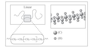
Figura 2: Representações esquemáticas da estrutura do PEAD
