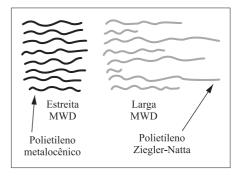
**Figura 6.** Comparação entre a distribuição de peso molecular de polietileno (MWD) produzido por catalisadores metalocênico e Ziegler-Natta<sup>[50]</sup>
