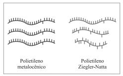
**Figura 7.** Teor (A) e distribuição (B) de comonômeros incorporados nas cadeias de polietileno produzido por catalisadores metalocênico e Ziegler-Natta<sup>[50]</sup>
