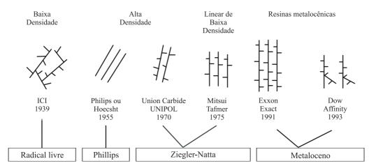
Figura 5. Evolução da estrutura do polietileno[40]
