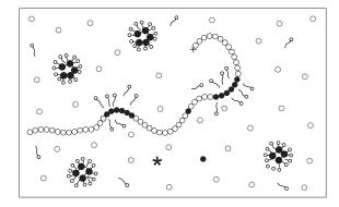
Figura 1. Representação esquemática do meio reacional na copolimerização micelar, sendo: (○) monômero hidrossolúvel; (●) monômero hidrófobo; (○—) tensoativo
