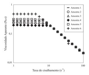
**Figura 4.** Comportamento viscosimétrico das soluções originais de polimerização micelar das amostras 1 a 6, obtidas em reômetro Contraves L.S-40
